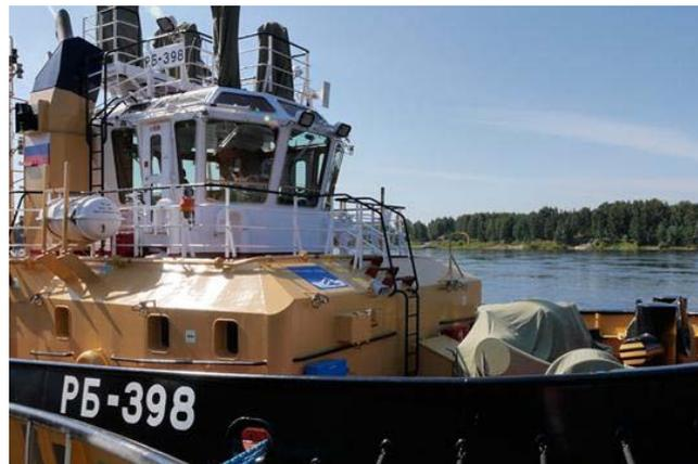
Arc4 R3 Aut3 Tug по классификации РС. Пропульсивный комплекс: 2 ВРК Rolls-Royce US 155, ВФШ в насадке. Силовая установка: 2x746 кВт при 1800 об/мин, Caterpillar C32.
